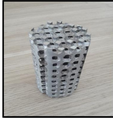
Şekil 1. T6 ısıl işleminde kullanılan Düzenli gözenekli açık gözenekli AA6061 Alüminyum numune.
