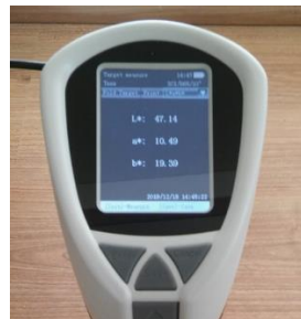
Şekil 2. Renk ölçüm cihazı (A) ve CIELAB renk uzayı (Molino ve ark., 2013) (B)
