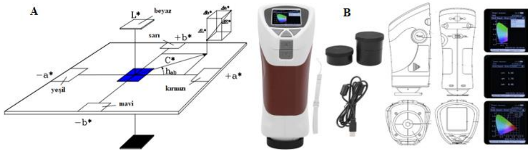
Şekil 1. DIN 6174, (1979)'e göre CIE- L^*a^*b^* sistemi (A) ve renk ölçüm cihazı (B)
