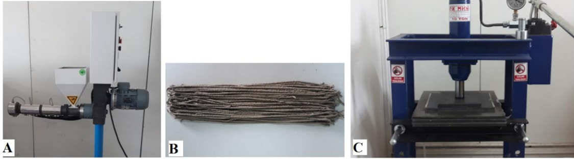
Şekil 4. Extruder makinesi (A), filamentler (B) ve presleme (C)
